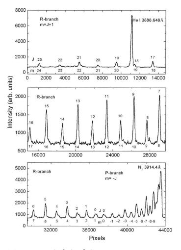
Fig. 3. Emission spectra of  $N_2^+$  B<sup>2</sup> $\Sigma_u^+$  - X <sup>2</sup> $\Sigma_g^+$ .
